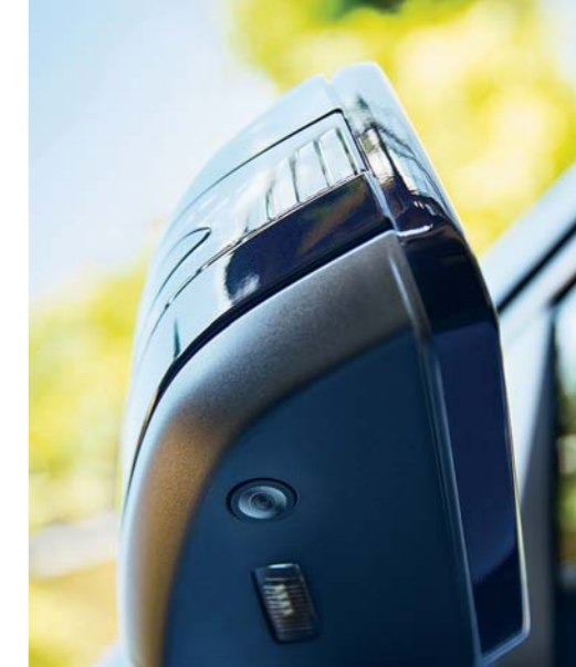
Вид сверху: камеры под боковым зеркалом (сверху) и желтые направляющие на экране (справа) позволят легко справиться даже с самым сложным маневрированием
