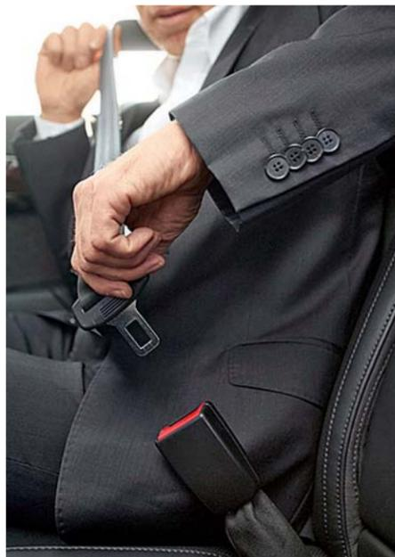
Замки ремней безопасности в автомобилях Mercedes-Benz теперь могут автоматически выдвигаться из подушек сидений. Новая технология придумана инженерами компании для пассажиров, расположившихся на заднем диване. Принцип ее работы заключается в следующем: при открытии задних дверей замки ремней безопасности автомати-
